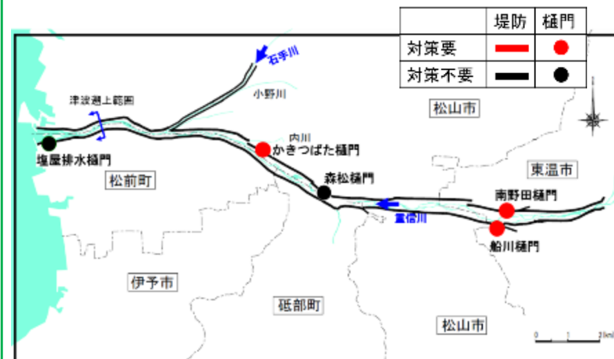
耐震対策実施状況 (H26.3)
