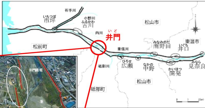
整備計画の目標流量規模の洪水が発生した場合、「井門霞堤」では開口部からの氾濫により浸水面積約15ha、浸水家屋22戸が想定されるため、浸水被害の解消のため、本川の堤防を下流側に延伸(延長80m)する整備を行います。
