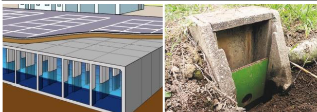
雨水貯留施設
