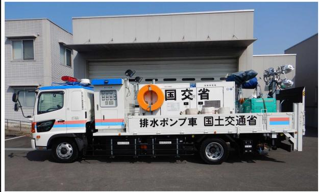
排水ポンプ車（総排水量30m<sup>3</sup>/min）
