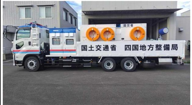
排水ポンプ車（総排水量60m<sup>3</sup>/min）
