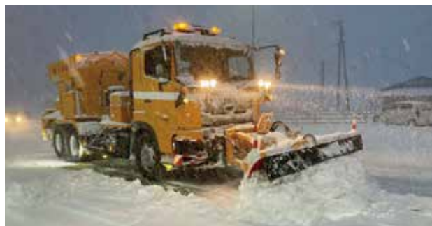
除雪板付凍結防止剤散布車による除雪作業
