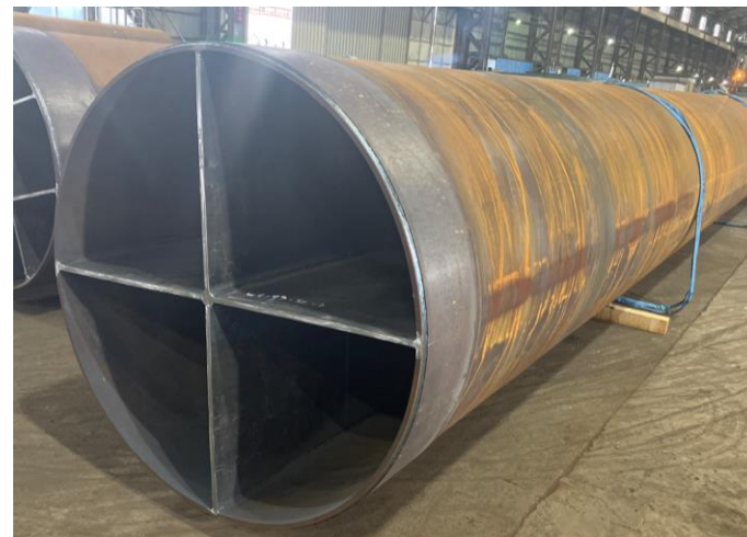
鋼管杭先端の補強箇所(標準部)
