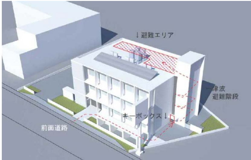
地域性：屋上に一時避難場所の機能付与 津波避難ビル (収容111名)
