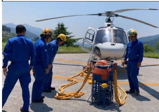
写真-1 投下型水位計吊り込みの様子
