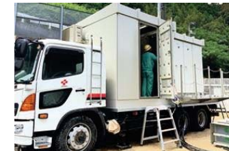
移動用変電設備 (キュービクル車)
