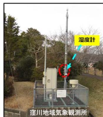
図-2-4-10 水蒸気監視能力の強化に伴うアメダス湿度計の設置
