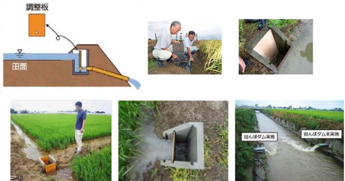
図 2-1-38 水田貯留の例（写真：新潟県 HP 田んぼダム写真より）
