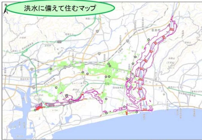
※この地図は、右岸9.2kが破壊した場合のみで分析しているため、他の地点が破壊した場合でも分析をし、重ね合わせる作業が必要
