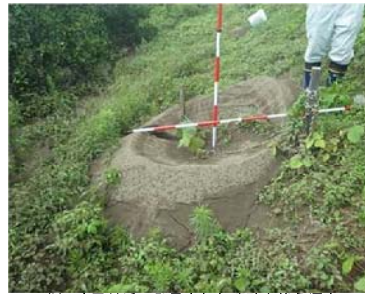
(b) 法尻付近で発見された噴砂を伴う漏水
