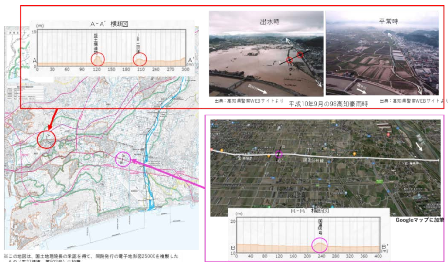
図 2-2-7 平成 10 年水害時に盛土構造物（国道 55 号、JR 土讃線）が氾濫水拡散を抑制
