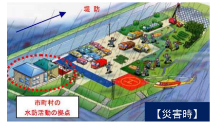
▲河川防災ステーション
