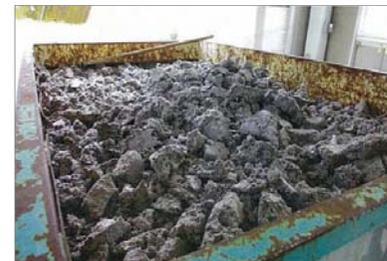
浄化施設により除去したSSの脱水後堆積物
