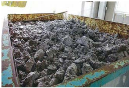
相生川から除去したSSの脱水後堆積物
