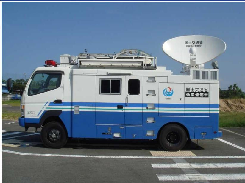
災害時に緊急出動し、通信衛星を利用して国土交通省専用無線通信回線に接続し画像電送、電話等の通信回線を構築し、被災現場等の情報を災害対策本部等に伝えることが可能です。
