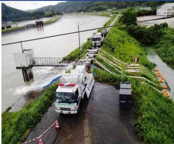
河川はん濫や津波等での災害発生現場へ緊急出動し、浸水箇所へ排水ポンプを投入し内水排除を行います。
