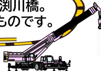
PCコンポ橋とは、工場で分割製作された主桁を現場に運搬、接合後、架設し、その上に場所打ちコンクリートを施工する合成桁橋です。架設方法は様々ありますが、今回はクレーン架設にて施工します。
