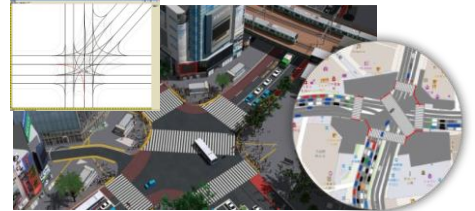
車種別割合、時間交通量設定による交通流生成と衝突制御が行える交通流シミュレーション
