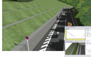
地図データ読込、複雑な道路構造を精緻に作成。切土・盛土の小段の幅、法面角度、テクスチャを段ごと、左右共に設定可能
