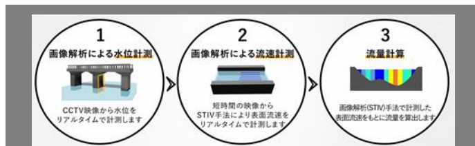
画像解析によるリアルタイム水位・流速・流量計測システム
