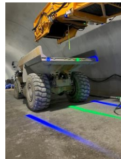
重ダンプ 誘導ライン
