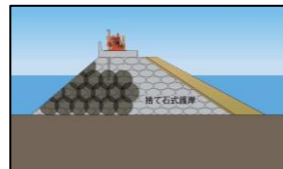
施工例：捨て石護岸の耐震補強
