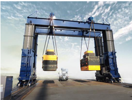
門型油圧リフター「TB-3000W」(せり上げ能力:300t) 油圧シリンダ等により伸縮するジャッキ機構と、ビーム(梁)を使って荷物をせり上げる揚重機械です。
