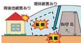
津波の越流で構造物や背後地に甚大な被害が
