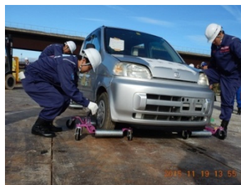
簡易移動装置による車両移動
