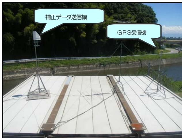
写真 5-1-2 基地局 (GNSS) の設置事例 (出典：巻末資料 i)
