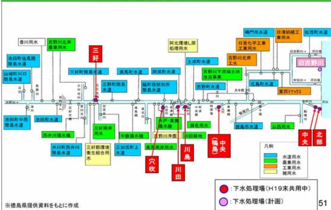
吉野川流域別下水道整備総合計画における下水道の吐口位置を上水取水位置とあわせて図示し紹介。旧吉野川流域下水は直接海に吐出する計画である。【議事概要-P6-52】
