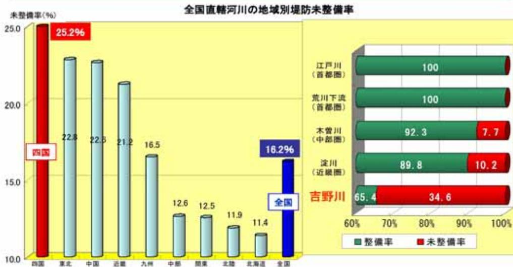
堤防未整備率:各河川で堤防が計画されている区間において堤防が完成していない割合 (出典:2004河川便覧)
