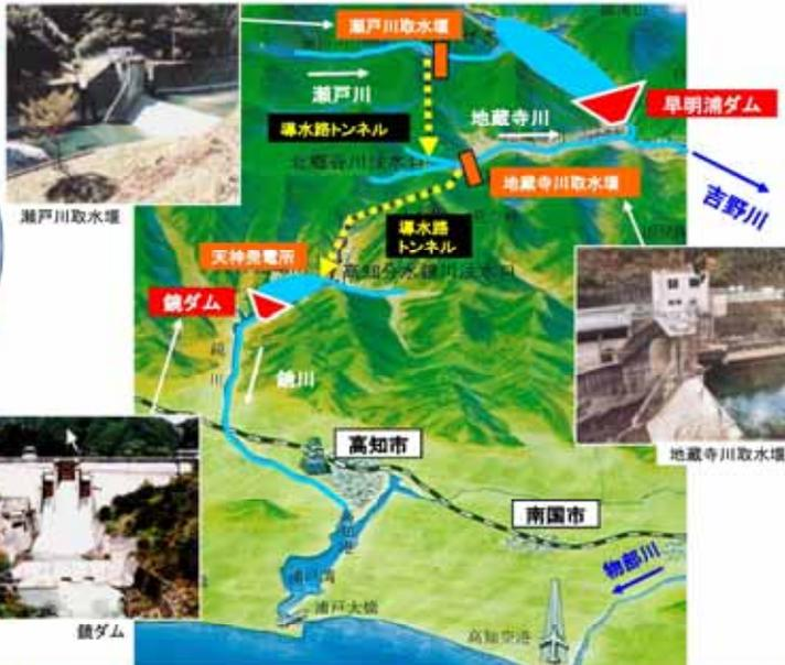
高知分水は、吉野川支川瀬戸川・地藏寺川の水を集め、高知市の水がめ、鏡ダムに注がれます。
