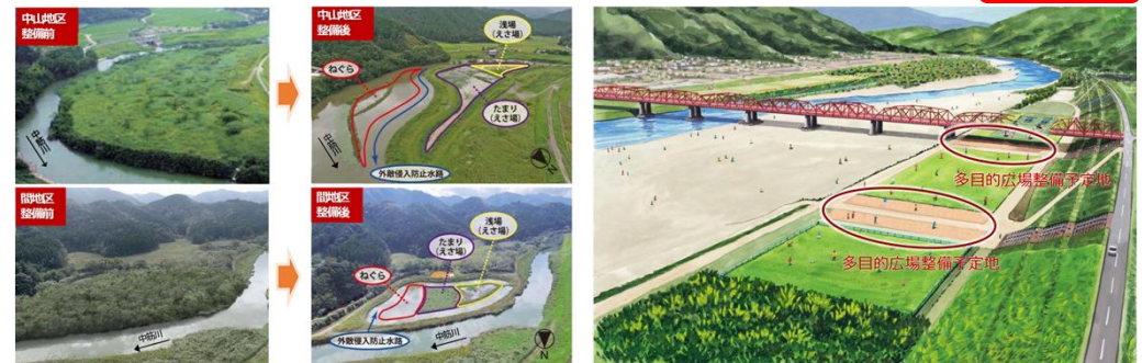
▲湿地環境の再生・創出の整備前後の状況（上：中山地区、下：間地区）
