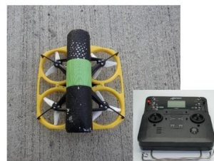
図-3 フロート付き小型ドローン(約20cm角、重量243g)
