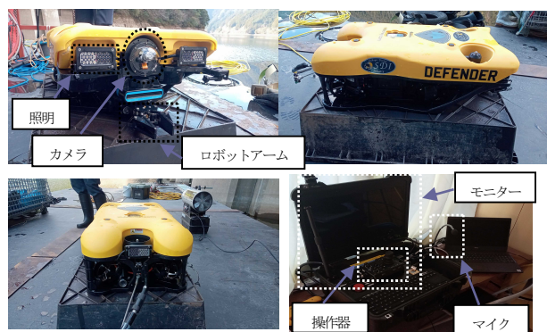
図-6 水中ロボットと操作機器
