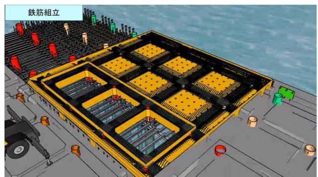
図-3 CIMモデル作業ステップ図 (支保を含めたモデル図)
