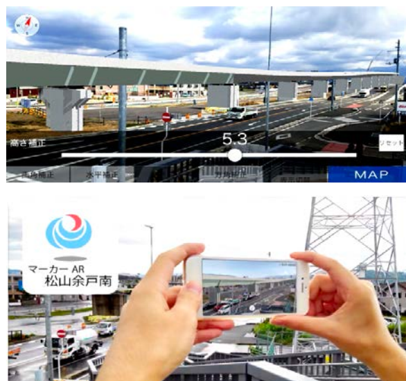
図-8 横断歩道橋上から見たARでの検証イメージ (上：ロケーションベースAR, 下：マーカーベースAR)
