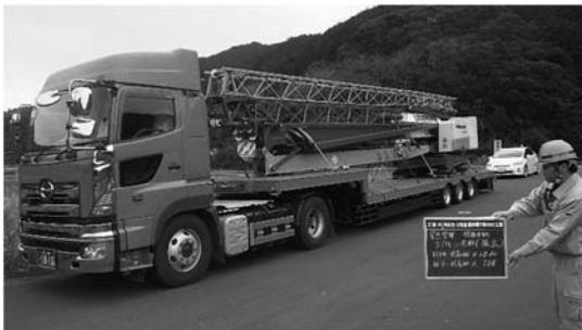
写真3 10tトラックによるジブクレーンの運搬
