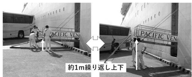
図-2 うねりによる船体動揺の状況
