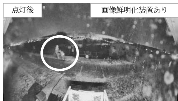
図5 照明点灯前後の識別状況（夜間） (□：検知、○：検知不可)
