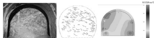
図6 人工知能 (AI) が評価に用いる画像 (左から、切羽写真、亀裂抽出画像、穿孔エネルギーコンター図)
