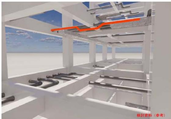
図-3 設備配管の納まりのチェック例
