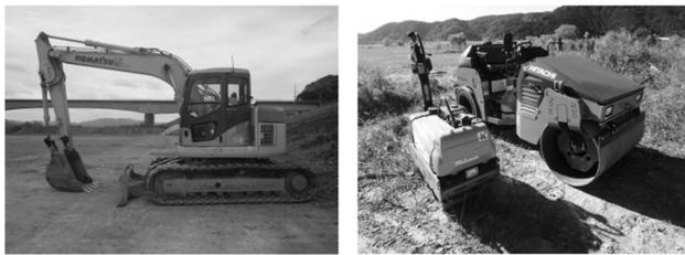
写真2 転圧機種 (左: BH、右: 振動ローラ2機種)
