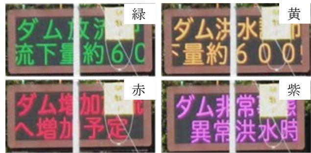
写真-4 電光表示板 4色表示イメージ
