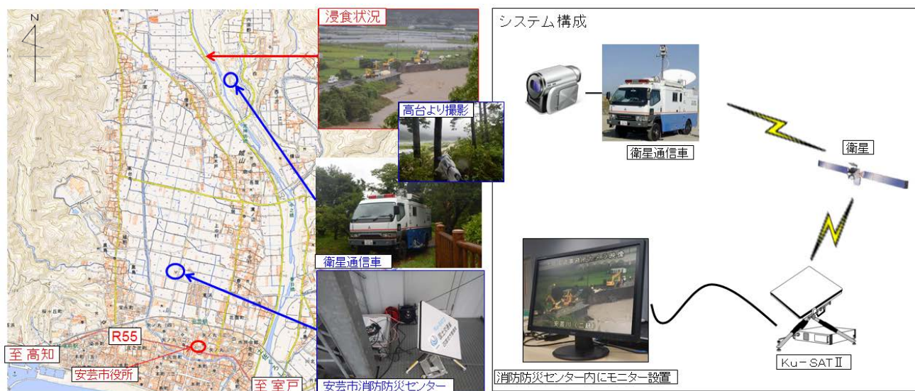
図-2 現地映像配信システム構成図
