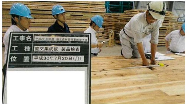
図7 製品検査状況
