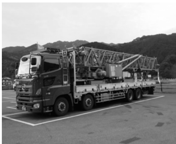
写真-3 10tトラックによるクレーン基部の運搬
