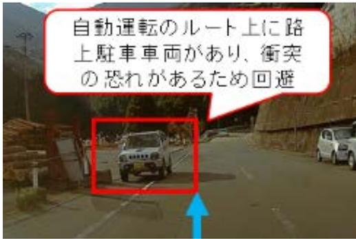
図7狭小幅員での路上駐車車両の回避例
