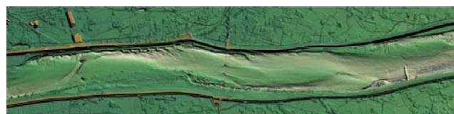
図－5 中流域の深掘れ状況（航空レーザ測量）
