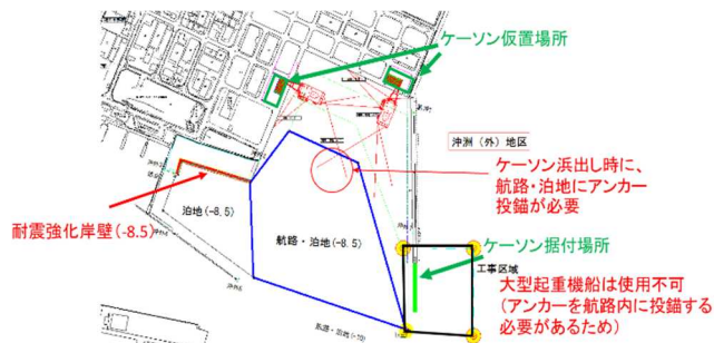
図-10 ケーソン据付イメージ図
