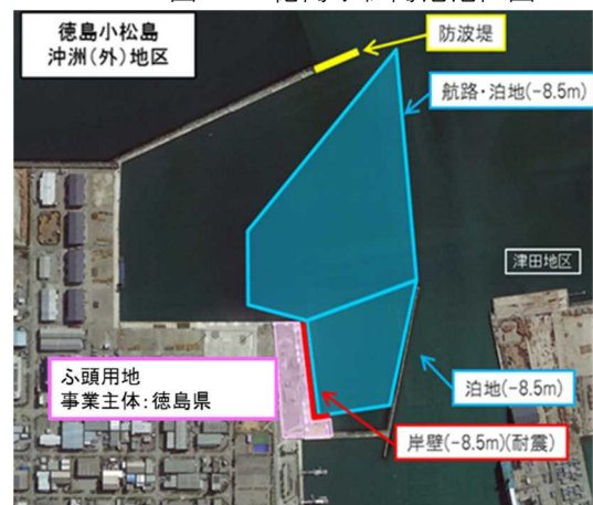
図-2 複合一貫輸送ターミナル整備事業 施設構成図
