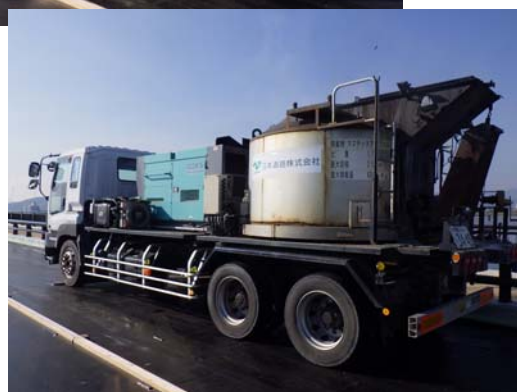
写真-2 ガス式クッカー車、電気式クッカー車
