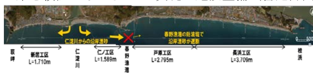
図-2 長浜～新居工区における沿岸漂砂模式図
