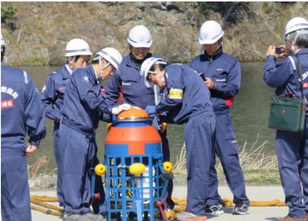
写真1 訓練中の様子 (投下型水位計の起動確認)
