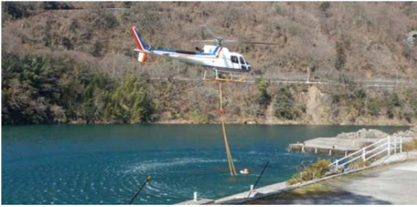
写真4 訓練中の様子（投下型水位計を投下・設置）
