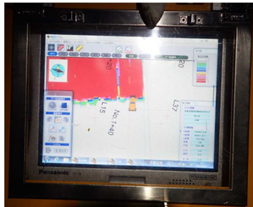
写真-6 転圧締固め管理システム モニタ状況
